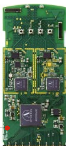
Una foto del chipset Atheros: sulla scheda Pc Card sono facilmente riconoscibili i circuiti corrispondenti ai blocchi funzionali dell'architettura e le quattro interfacce d'antenna.
