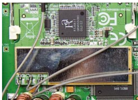
Il chip Mac/banda base RT2661 e il transceiver RT2529 (nella foto nascosto dalla schermatura metallica) compongono la soluzione Mimo XR.
